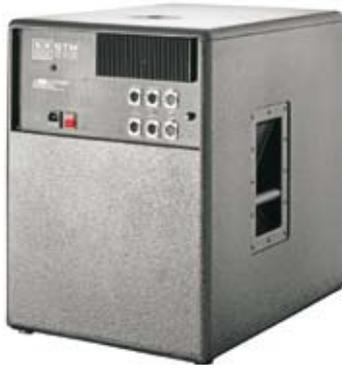
Brandneu von SR Technology ist der Sub-Bass STW 600. Druckvolle und satte Bässe zeichnen den universal anwendbaren Sub-Bass aus. Der 15" Woofer mit digitaler Endstufe leistet 600 W/RMS, bringt einen Schalldruck von 101 dB und arbeitet mit einer Stereo-Frequenzweiche (2 In/2 Out/ Mono). Das Gehäuse aus 6-schichtigem Birkenholz ist mit TSS Strukturlack beschichtet. Der Sub-Bass hat die Abmessungen 45 x 63,5 x 61 cm und wiegt 33 kg.
